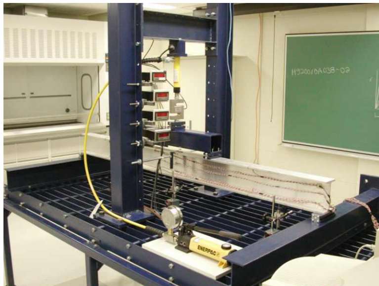
Fig 4 – Banc de flexion utilisé pour le chargement de la poutre.
